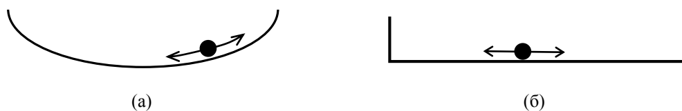
Рисунок 10.14. Металлический шарик в углублении: (а) устойчивая система, (б) неустойчивая система
