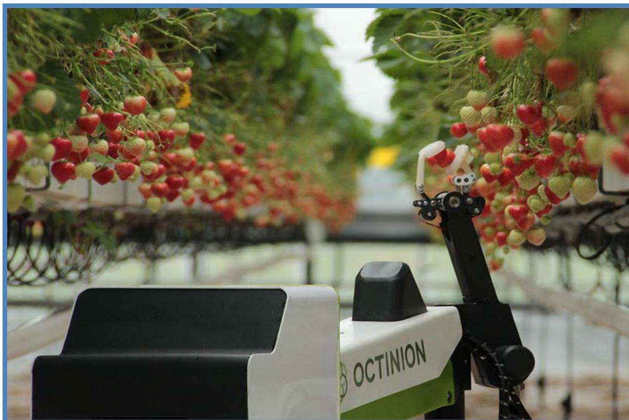
Рис 2. Беспилотный наземный автономный робот для сбора урожая
