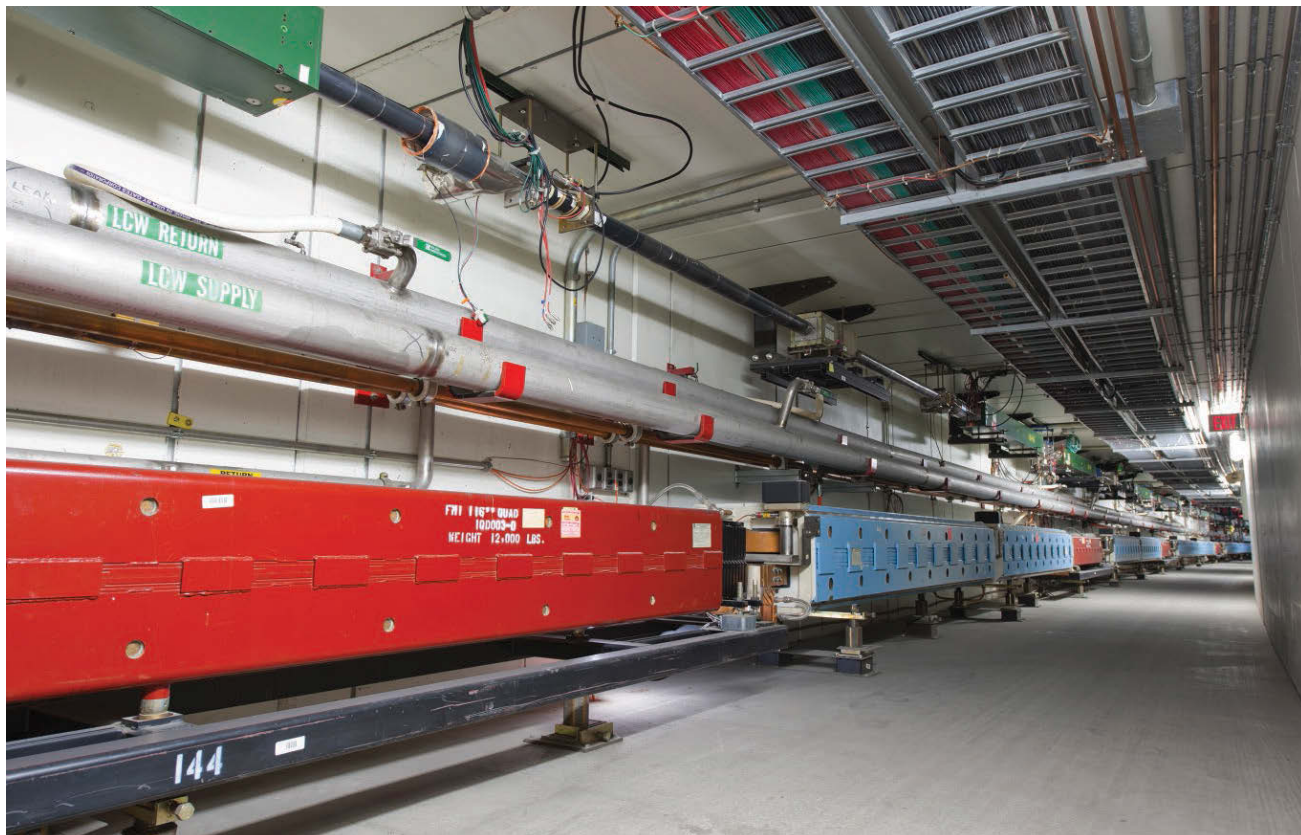
Главный инжектор Фермилаба: ускоряющее частицы подземное кольцо наращивает число протонов для создания пучков нейтрино, которые будут исследоваться в эксперименте DUNE
