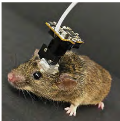
Микроскоп, закрепленный на голове живой мыши, позволяет исследователям наблюдать активность клеток мозга во время формирования памяти
