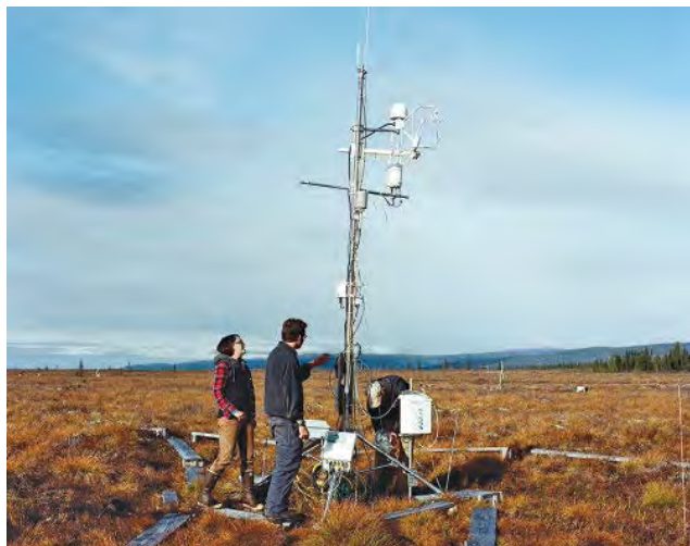
Контрольно-измерительная установка для круглогодичного определения оборота диоксида углерода и метана в почве и атмосфере показывает, испытывает ли экосистема чистую прибыль или потери газов ежегодно
